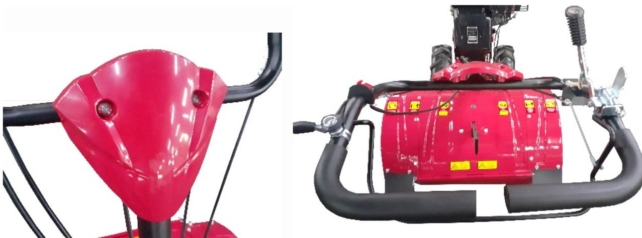
Перейдя вниз к фрезе увидим так же конструктивные изменения не только в самой фрезе, но и в ее кожухе, а именно на задней защитной крышке грунтофрезы установлен гребень, который способствует разбиванию комков земли, защита ножей с дополнительными крыльями, полностью закрывают рабочую часть фрезы как сзади и спереди.
