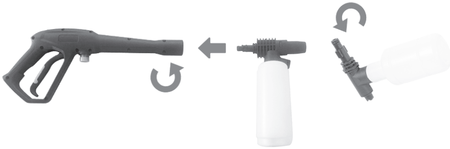
Рисунок 6. Схема встановлення пінної насадки.
