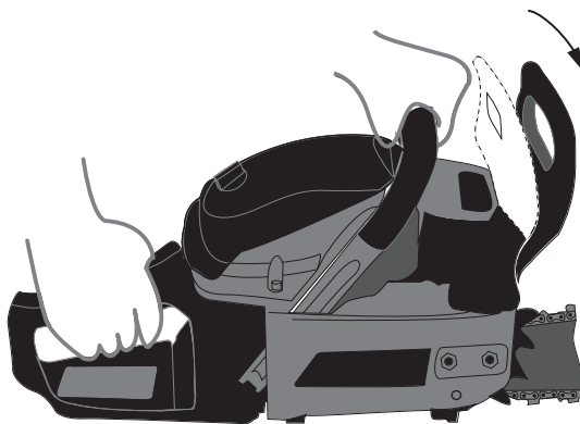
Рисунок 5. Схема роботи гальма ланцюга.
