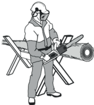
Рисунок 13. Схема розпилу колоди з використанням козлових опор.
