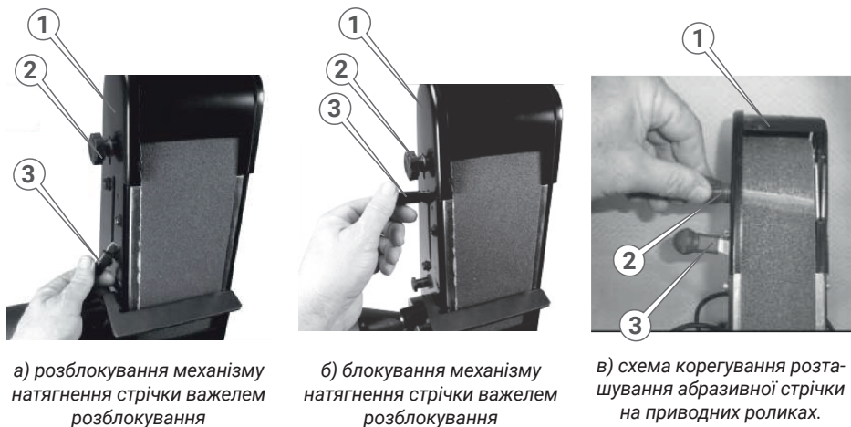
Рисунок 3. Схема заміни абразивної стрічки.
