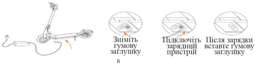
Рисунок 6. Схема зарядки батареї електросамокату.
